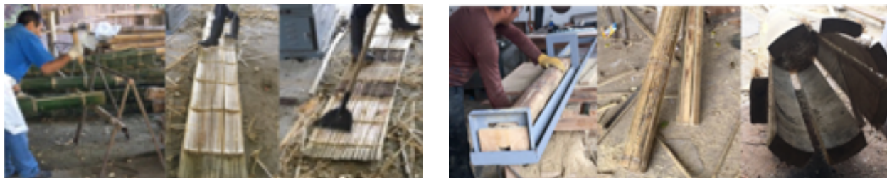
Figura 10. Producción de esterilla y reglilla por medios artesanales.
